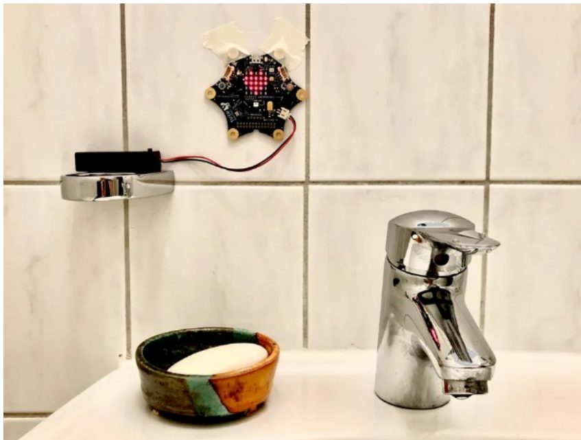
Abbildung 3.13: Kontaktlose Stoppuhr zum Händewaschen mit dem Calliope mini, Quelle: alicabs (2020)
